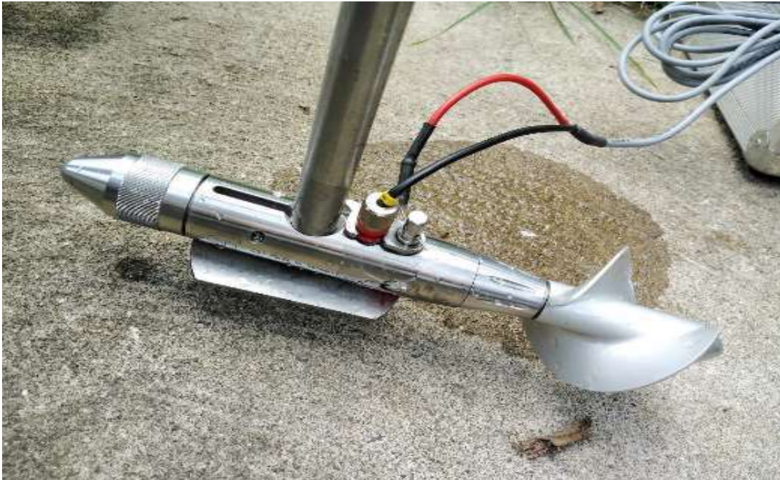
Figura 15. Molinete para el aforo del canal de drenaje
