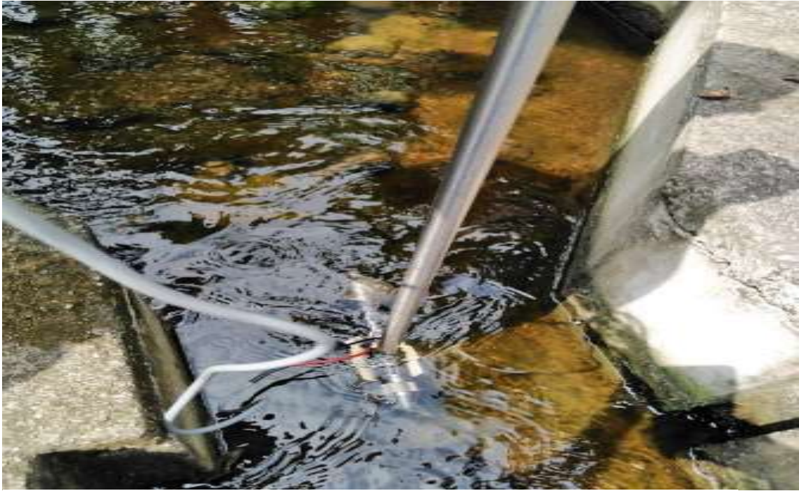
Figura 17. Aforo del canal de drenaje de las tinajas de lavado
