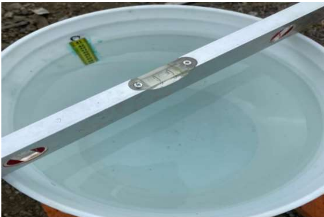
Figura 5. Nivelación del evaporímetro
