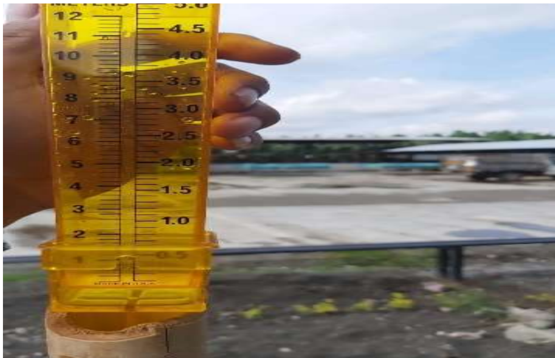
Figura 6. Instalación del pluviómetro en la finca
