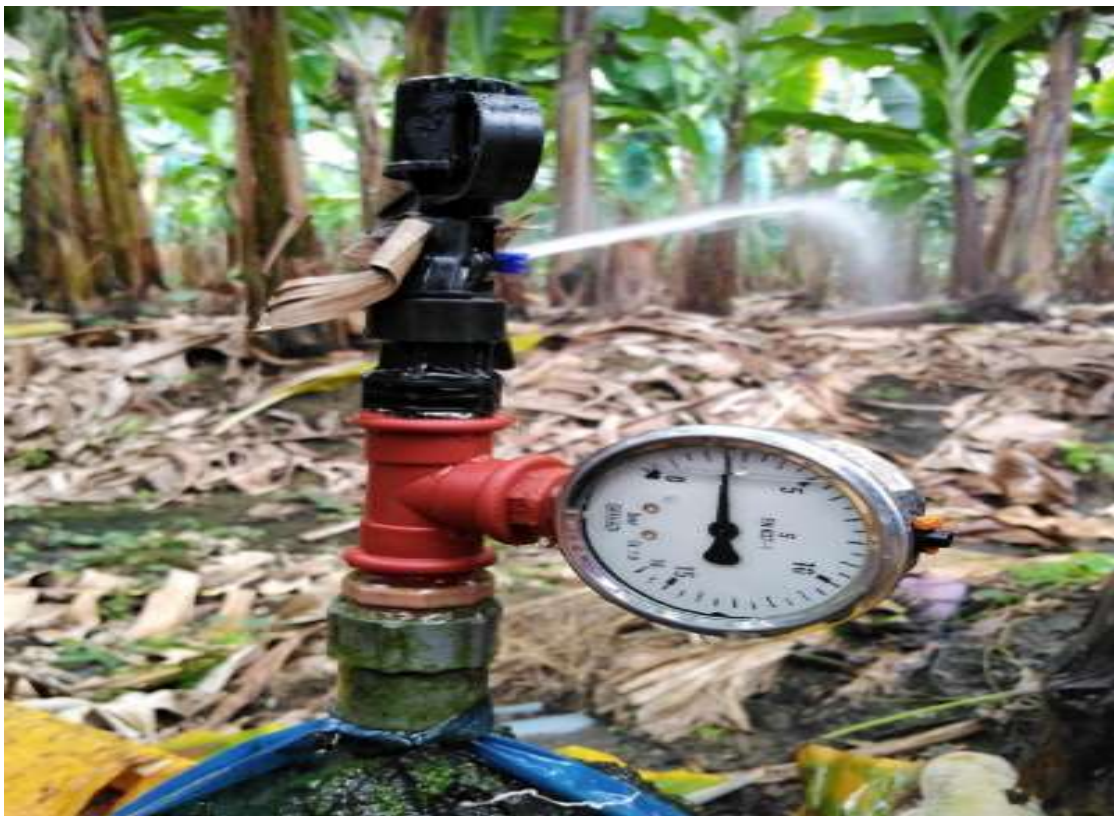
Figura 20. Medición de la presión del sistema de riego con el manómetro
