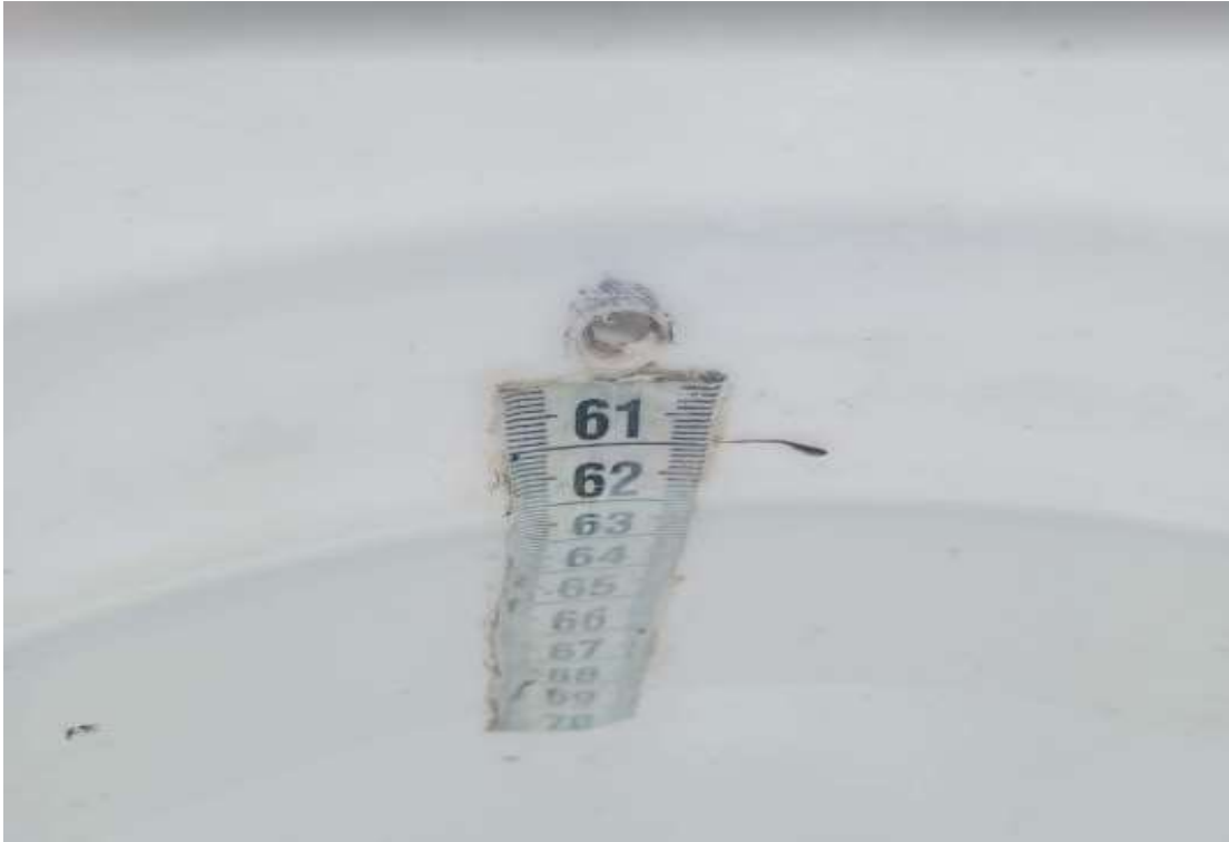
Figura 19. Toma de datos del evaporímetro
