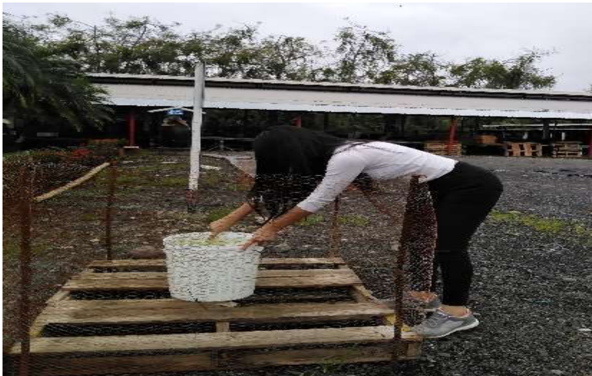
Figura 2. Instalación del evaporímetro
